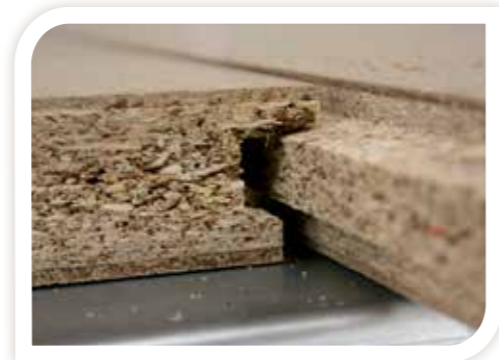
Nut- und Federverbindung (Standard) Die spezielle Pressung P6 700 kg/m 3 gewährleistet eine maximale Punktlast.
